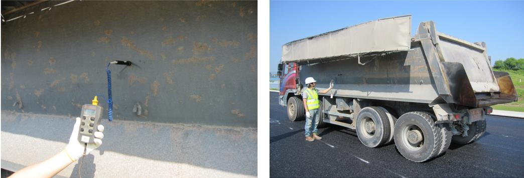
〈그림 6.2〉 운반 장비의 적재함 옆면 중앙부의 혼합물 온도 측정구 및 측정
