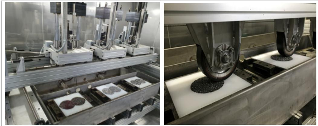
〈그림3.2〉 현장 코어를 이용한 동적안정도 시험
